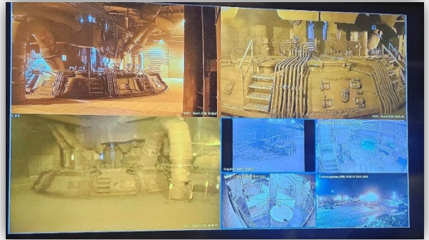
Hver av de tre ovnene overvåkes visuelt på skjermer, en skjerm per ovn.
