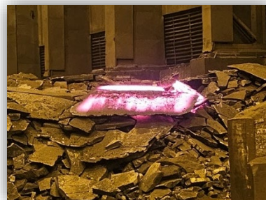
Mangan ligger til avkjøling for så å bli knust. Deretter blir den lastet på transportmiddel til kunde
