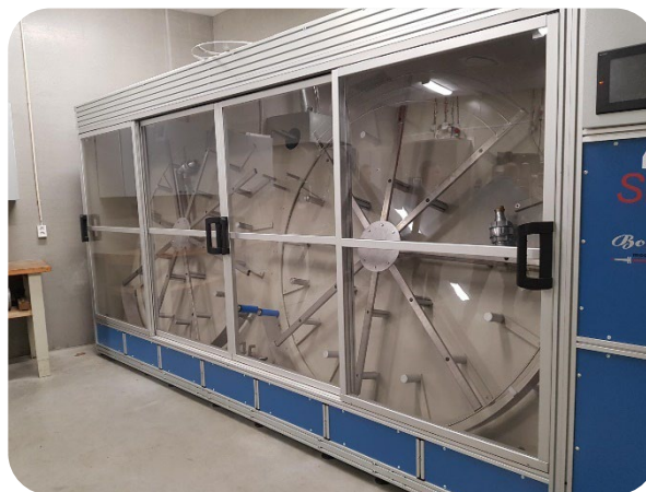
I denne maskinen blir slangene vasket og tørket for de kommer ut.....
